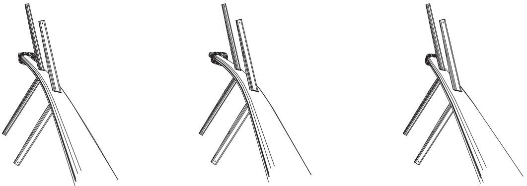
Mastfuß in korrekter Position
